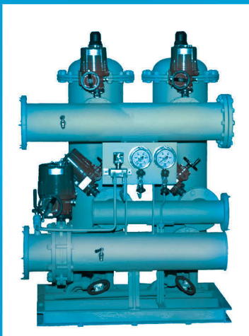
Опытный образец оборудования обезвреживания балласта методом фильтрации
