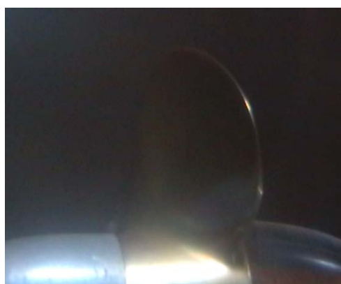
Рисунок 58 – Кавитация с засасывающей стороны лопасти J = 0.409
