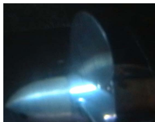
Рисунок 58 – Кавитация с засасывающей стороны лопасти J = 0.409
